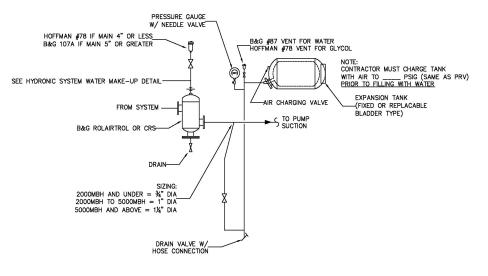
HORIZONTAL BLADDER TANK INSTALLATION DETAIL
